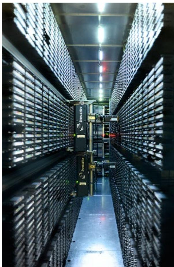
L'infrastructure du système SPAR : robotique de stockage sur bandes magnétiques
